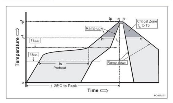
图 6.1 回流焊温度曲线图
