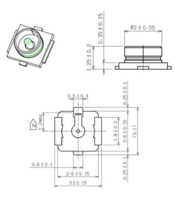
图 4.2 IPEX 连接器参考尺寸图
