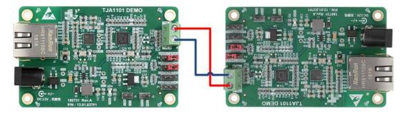
图 2.3 车载以太网连线示意图
