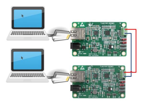
图 2.4 信号线连接示意图
