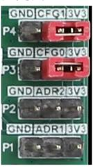
图 2.1 主机模式短路帽接法
