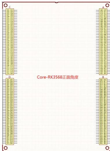
图 2.18 一体式原理图库
