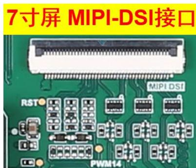
图 2.47 7 寸 MIPI-DSI 液晶屏接口
