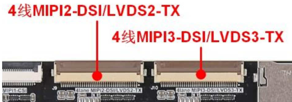
图 2.10 7 寸 MIPI-DSI 液晶屏接口
