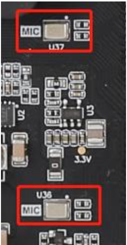
图 2.20 2 路 PDM 格式数字 MIC 输入
